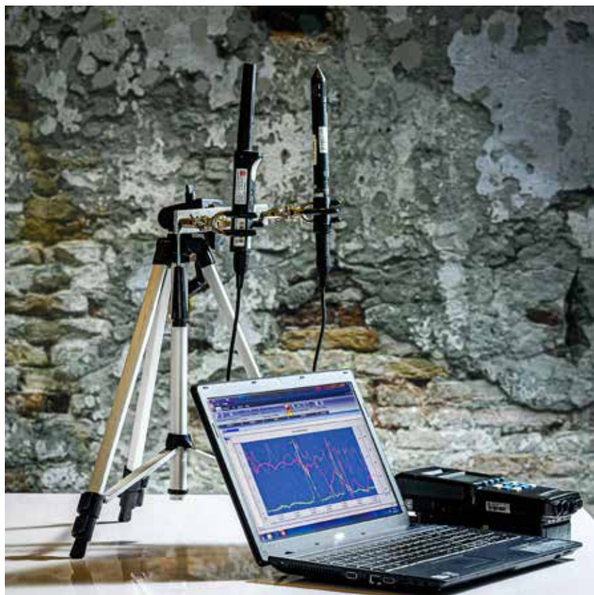
Meetboom voor de meting van het binnenklimaat.
